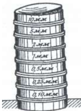
Рис. 1. Комплект сит для гранулометрического анализа
