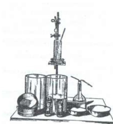
Рис. 2. Прибор Сабанина для гранулометрического состава
